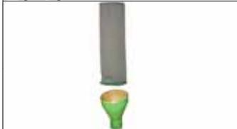
**Cône d'adaptation manche à air sur auget d'élevateur à palettes pour reprise sous broyeur**
