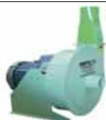
**BROYEURS à MARTEAUX type T3 avec ventilateur**
