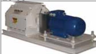
**BROYEUR T60 NG****Rotor 156 marteaux - double grilles****Grille Ø3,5 mm****Sans coffret de commande (voir Chap Automation)****1500tr/min pour concassé - 3000tr/min pour fin**
