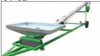
**VIS SUR CHARIOT Ø200 mm - 40T/h à 45° selon céréales****Trémie d'entrée 2 m x 1 m -Trappe de réglage de débit****Roues pneumatiques - barre d'attelage - 25km/h maxi - Tronçon repliable pour transport - treuil de levage - Tubes galvanisés****Coffret étanche comprenant disjoncteur inverseur + bobine manque de tension - châssis traitement de surface EPOXY**
