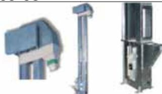
**ELEVATEURS à GODETS galvanisés 500 Qx/heure****Groupe de commande et moteur - système anti-retour - carter****Pied avec gousset - sangle avec godets - entrée et sortie carré 200****Tuyauterie Ø200 (500 Qx) - Hauteur hors tout avec 1m de tête et 1m de pied****A partir de 18m, conduit en 2m**
