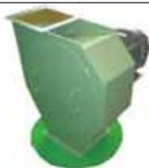
**BROYEUR GRAVITAIRE type ETS****Rotor 42 marteaux****Grille Ø à définir****Sans coffret de commande (voir Chap Automation)****1500tr/min pour concassé - 3000tr/min pour fin**
