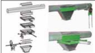
**Sortie intermédiaire de VIS HORIZONTALES Ø160 mm**
