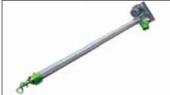
**VIS ELEVATRICES Ø100 mm transmission par courroies****Débit 70 à 100 Qx/heure selon céréales****Ame filet 15x21 - filet ép 3/1,5****Sortie 100 x 150 - pied de vis simple**
