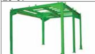
**PASSERELLE + main courante placée au dessus mélangeur pour accès personne**
