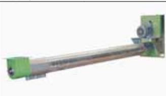
**VIS HORIZONTALES Ø200 mm transmission par courroies - moteur à tirer**
