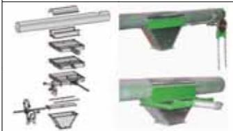
**Sortie intermédiaire de VIS HORIZONTALES Ø200 mm**
