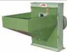
**BROYEUR type BB****Rotor avec 16 marteaux****Trémie standard - aimant - tuyère à maïs****Démarrreur E.T. - disjoncteur - 1 grille**
