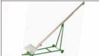
**VIS SUR CHARIOT Ø160 mm - 22T/h à 45° selon céréales****Trémie d'entrée 2 m x 1 m -Trappe de réglage de débit****Roues pneumatiques - barre d'attelage - 25km/h maxi - Tronçon repliable pour transport - treuil de levage - Tubes galvanisés****Coffret étanche comprenant disjoncteur inverseur + bobine manque de tension - châssis traitement de surface EPOXY**
