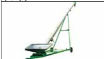
**VIS SUR CHARIOT Ø240 mm - 60T/h à 45° selon céréales****Trémie d'entrée 2 m x 1 m -Trappe de réglage de débit****Roues pneumatiques - barre d'attelage - 25km/h maxi - Tronçon repliable pour transport - treuil de levage - Tubes galvanisés****Coffret étanche comprenant disjoncteur inverseur + bobine manque de tension - châssis traitement de surface EPOXY**
