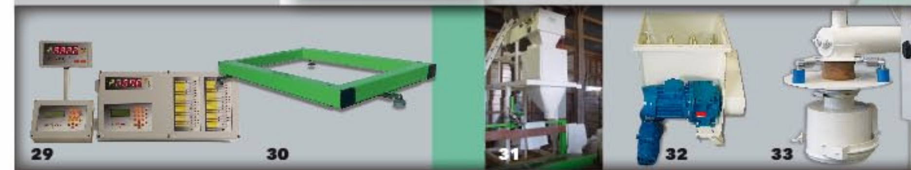
29 : Automates, pilotage de production par PC de contrôle. - 30 : Châssis de pesage - 31 : Peseuse ensacheuse et banc-couseur - 32 : Micro doseur volumétrique - 33 : Vis doseuse ensacheuse
