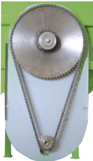
Transmission par chaîne et pignons aciers
