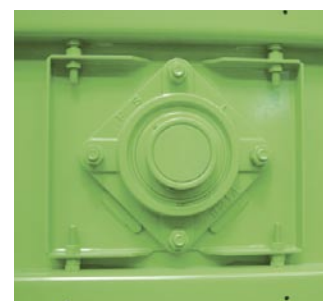
Possibilité de réglage du jeu entre le fond de cuve et la spire
