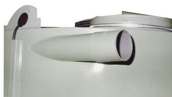
**Entrée tangentielle des farines pour remplissage pneumatique par broyeur**
