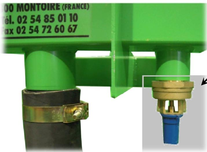
Si la dépression du circuit devient trop forte, le clapet s'ouvre et laisse entrer de l'air.
