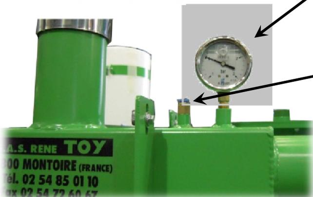
Ce manomètre indique la pression ou la dépression dans le circuit
