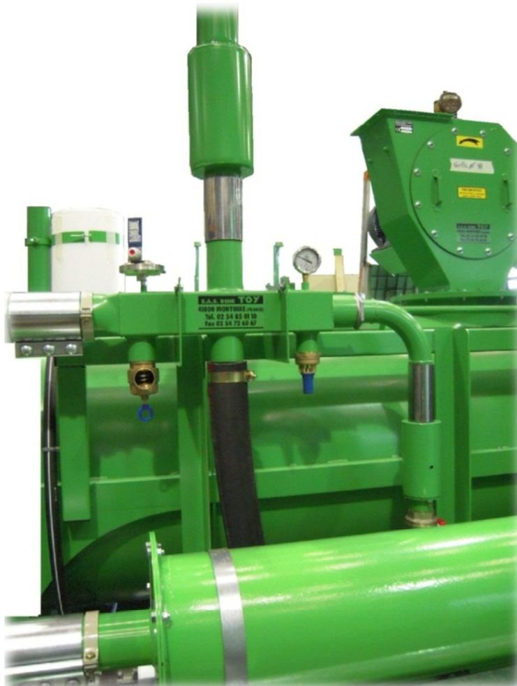
En règle générale le FALIP travaille en aspiration de - 0,3 à - 0,5 bar environ et refoule en pression de +0,8 à 1bar environ.
