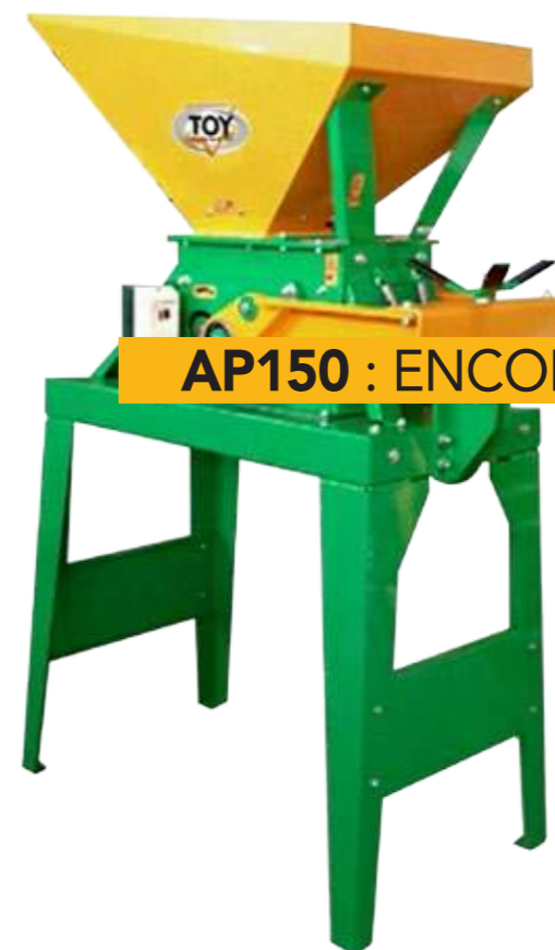
Des trémies équipées d'aimants puissants pour une protection contre les métaux ferreux.
