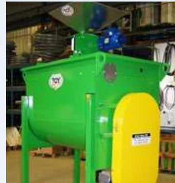
Aplatisseur AP60 sur mélangeur
